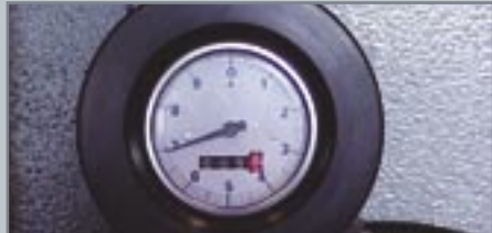
Regolazione angolo manuale Ручная установка угла гибки
