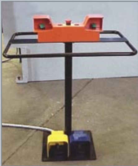
Comando bimanuale (norme CE) Двуручное управление
