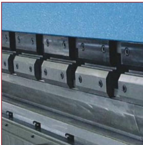
Bloccaggio utensile superiore in versione manuale, a intermedi, idraulico e con centinatura manuale
