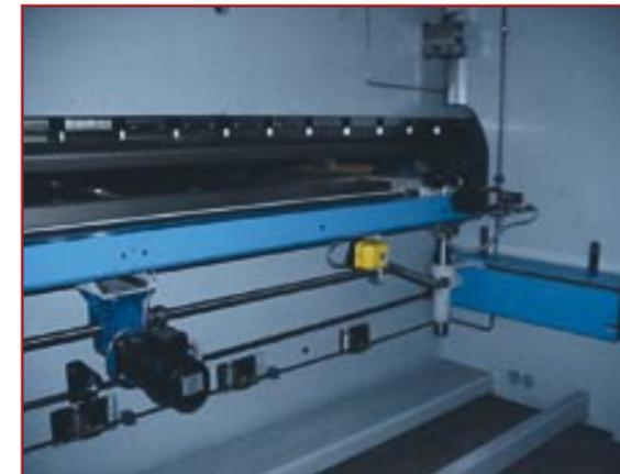
**Tope trasero mod. RSP conectado al control numerico y realizado con tornillos de bolas rectificadas y servomotores en c.c. Tope trasero disponible en diferentes configuraciones para cumplir con la demanda del cliente. Motorización ejes X y R de base con la posibilidad de colocar asta 5 ejes (X1-X2-R-Z1-Z2)**
